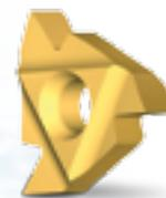
Превосходный твердый сплав общего назначения с композиционным многослойным износостойким покрытием и верхним рабочим слоем из нитрида титана (TiN), обеспечивающий высокую эффективность при обработке обычных и нержавеющей сталей.
