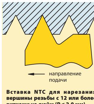
**Вставка NTC для нарезания вершины резьбы с 12 или более витками на дюйм ( $P \leq 2,0$  мм)**
