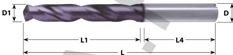
Максимальная глубина обработки  $t_{\max} = L1 - 1,5 \times D$
