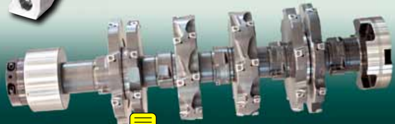
9 Ébauche des paliers de vilebrequin et alésage des demi-paliers par contre-alésage Roughing of crank bore cheeks and boring of crankshaft half with 'counter boring'
