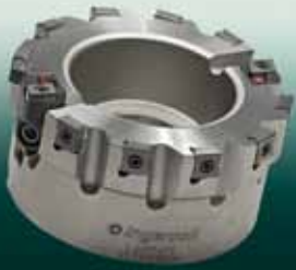
1 Ébauche de la surface du joint de culasse et du carter d'huile, semi-finition avec plaquettes carbure monobloc et plaquettes VK2V PCD réglables 1D Roughing of cylinder head side and oil pan side and semi-finishing with solid carbide insert and 1D-adjustable PCD inserts VK2V
