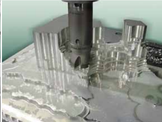
Fraise pour épaulements à plaquettes carbure à 4 arêtes polies Shoulder mill cutter with 4 edged-polished carbide inserts
