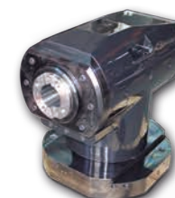
Автоматический поворот вокруг оси шпинделя станка Угол наклона инструмента 90° Мощность 52 кВт Вращающий момент 2500 Н·м
