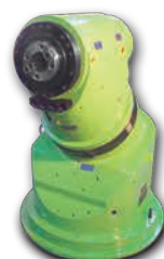
Автоматический поворот вокруг двух осей Конус ISO 50 Вращающий момент 4100 Н·м
