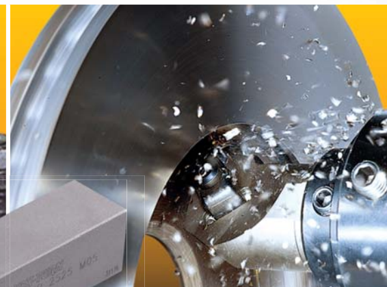
Hexturn Außendrehwerkzeug mit 12 eff. Schneiden. Seite 105+112 Hexturn, 12 corners. Page 105+112
