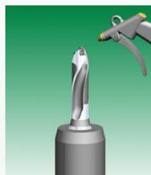
2) Очистите посадочные поверхности посредством воздушной струи.
