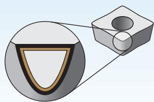
Покрытие обеспечивает возможность выполнения высокоскоростной чистовой и тяжелой черновой обработки.
