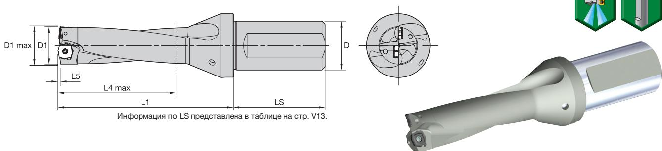
**■ Сверло Top Cut 4 • Метрическая система • 3 x D • Хвостовик с лыской**
