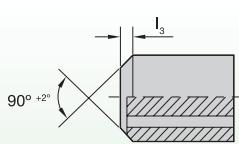
Хвостовик для обработки с минимальным использованием СОЖ по DIN 69090-3
