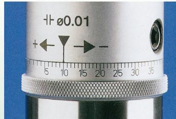
После грубой регулировки державки с пластины осуществляется окончательная настройка на размер посредством вращения лимба на расточной головке. Данный метод не имеет погрешности.
