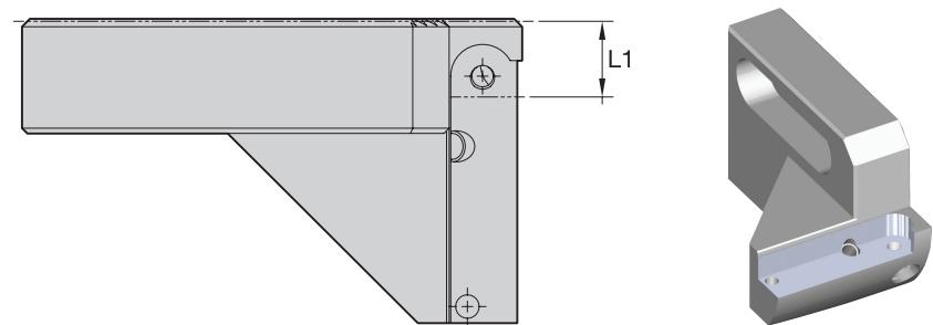
■ Направляющая для картриджей с микрорегулированием
