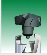
6) Извлеките режущую пластину (работайте в перчатках во избежание возможных повреждений).
