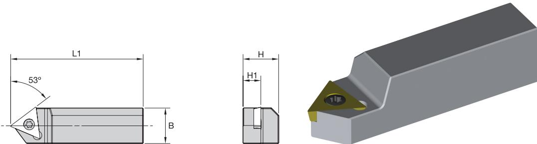
■ Державки под пластины прецизионной головки • Тип С
