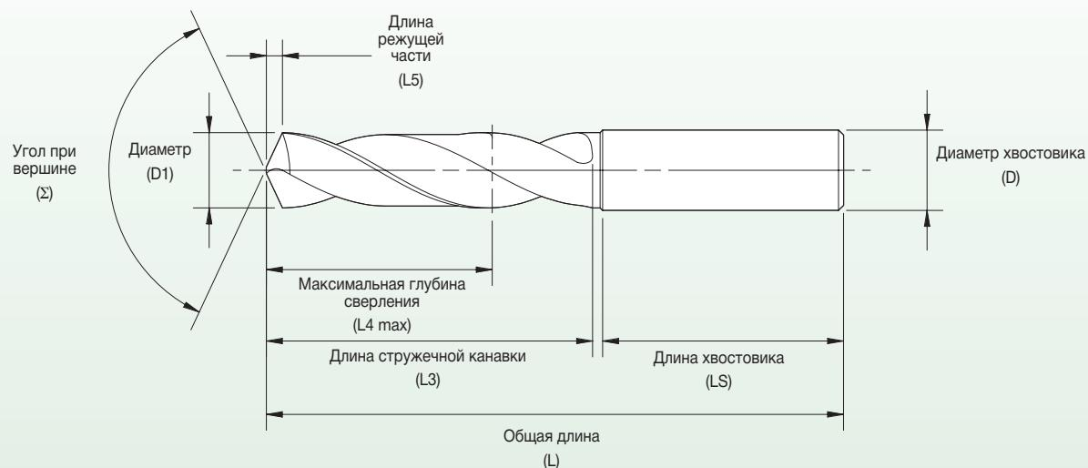
Используйте данный пояснительный чертеж при описании конструктивных особенностей цельного твердосплавного ступенчатого сверла.
