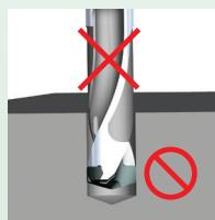
3) Обработка без использования СОЖ не рекомендуется. При обработке чугуна возможности применения ограничены, настоятельно рекомендуется обработка с минимальным использованием СОЖ (масляный туман).
