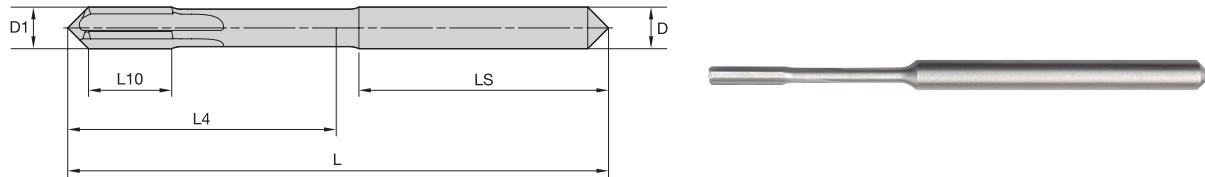
■ Развертки HSR с прямыми канавками для глухих отверстий • K10F™ /K10F-DCFD™ • 2–4 мм
