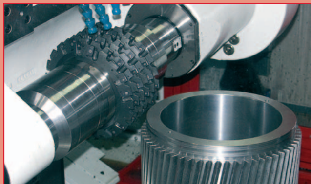
Черновая обработка червячной фрезой Шестерня с модулем 12, z = 45 , материал 18X2H2M
