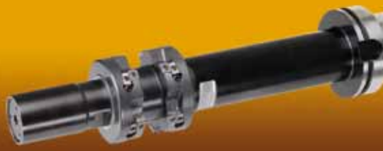
11 Finition des paliers de vilebrequin avec plaquettes PCD réglables 1D sans contre-alésage Finishing of crank bore cheeks with 1D-adjustable PCD inserts 'without counter bearing'
